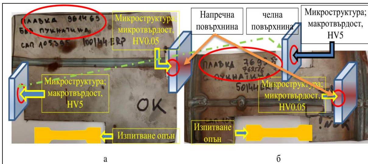
Фигура 1. Изследвани плазмено заварени обекти и позиции: а) проба 1 без видима пукнатина; б) проба 2 с пукнатина в метала на шева
