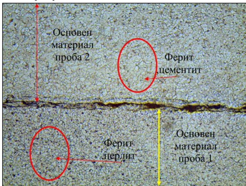
Фигура 9. Сравнителна микроструктура на основния материал на проби 1 и 2 при \times 100 с оригиналните фазови означения
