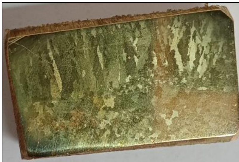
Фигура 2. Макроструктура на радиалната проба: дендритна зона към външната повърхност и зона с равноосни кристали към вътрешната повърхност
