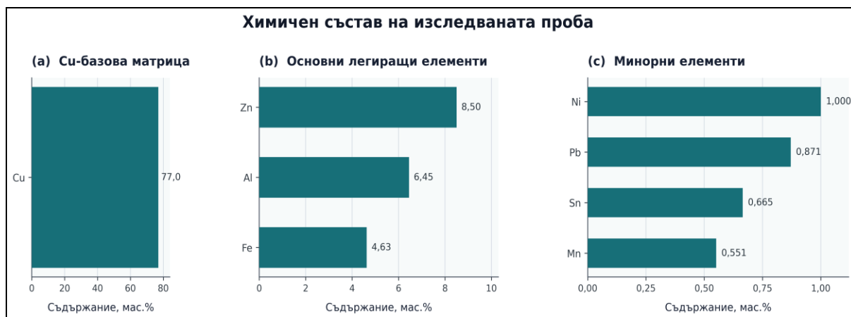
Фигура 3. Среден химичен състав на изследваната проба: Cu-базова матрица, основни легиращи елементи и минорни компоненти. Стойностите са представени като мас.% без допълнително нормализиране.
